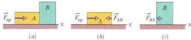
**FIG. 5-20** (a) Uma força horizontal constante  $\vec{F}_{\text{ap}}$  é aplicada ao bloco A, que empurra o bloco B. (b) Duas forças horizontais agem sobre o bloco A. (c) Apenas uma força horizontal age sobre o bloco B.
