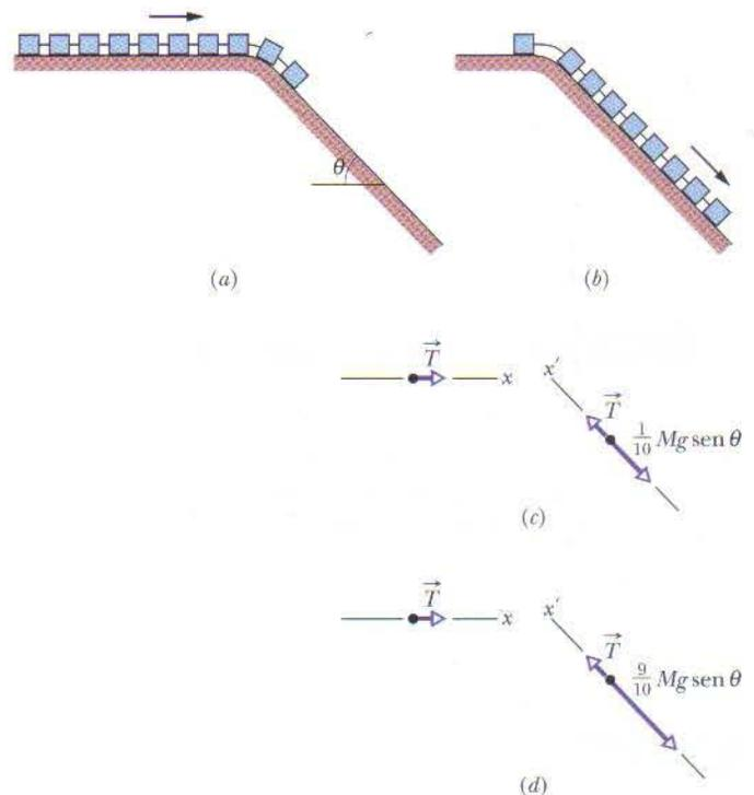
**FIG. 5-17** Uma montanha-russa (a) com o primeiro carro na rampa e (b) com todos os carros na rampa, exceto o último. (c) Diagramas de corpo livre dos carros na horizontal e do carro na rampa, como em (a). (d) Diagrama de corpo livre para a situação mostrada em (b).
