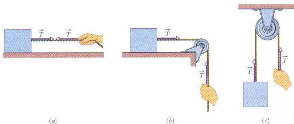
**FIG. 5-9** (a) A corda esticada está sob tensão. Se sua massa é desprezível a corda puxa o corpo e a mão com uma força  $\vec{T}$ , mesmo que a corda passe por uma polia sem massa e sem atrito, como em (b) e (c).
