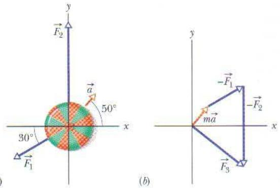
**FIG. 5-4** (a) Vista superior de duas das três forças que agem sobre uma lata de biscoitos, produzindo uma aceleração  $\vec{a}$ .  $\vec{F}_3$  não é mostrada. (b) Um arranjo de vetores  $m\vec{a}$ ,  $-\vec{F}_1$  e  $-\vec{F}_2$  para determinar a força  $\vec{F}_3$ .
