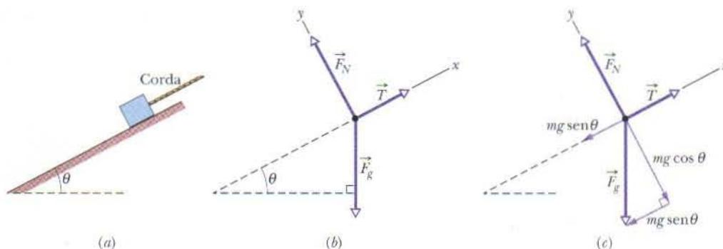
FIG. 5-16 (a) Uma caixa sobe um plano inclinado, puxada por uma corda. (b) As três forças que agem sobre a caixa: a força da corda  $T$ , a força gravitacional  $F_g$  e a força normal  $F_N$ . (c) As componentes de  $F_g$  na direção do plano inclinado e na direção perpendicular.
