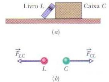
**FIG. 5-11** (a) O livro  $L$  está apoiado na caixa  $C$ . (b) As forças  $\vec{F}_{LC}$  (força da caixa sobre o livro) e  $\vec{F}_{CL}$  (força do livro sobre a caixa) têm o mesmo módulo e sentidos opostos.
