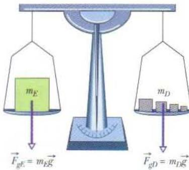
**FIG. 5-5** Uma balança de braços iguais. Quando a balança está equilibrada a força gravitacional  $\vec{F}_{gE}$  a que está submetido o corpo que se deseja pesar (no prato da esquerda) e a força gravitacional total  $\vec{F}_{gD}$  a que estão submetidas as massas de referência (no prato da direita) são iguais. Assim, a massa  $m_E$  do corpo que está sendo pesado é igual à massa total  $m_D$  das massas de referência.
