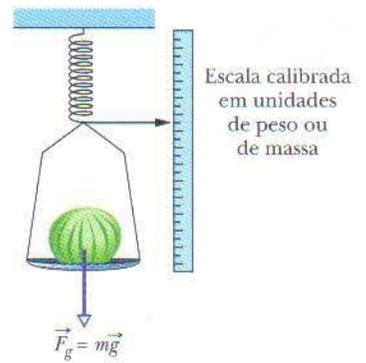
**FIG. 5-6** Uma balança de mola. A leitura é proporcional ao peso do objeto colocado no prato, e a escala fornece o valor do peso se estiver calibrada em unidades de força. Se, em vez disso, estiver calibrada em unidades de massa a leitura será igual ao peso do objeto apenas se o valor de  $g$  no lugar onde a balança está sendo usada for igual ao valor de  $g$  no lugar onde a balança foi calibrada.
