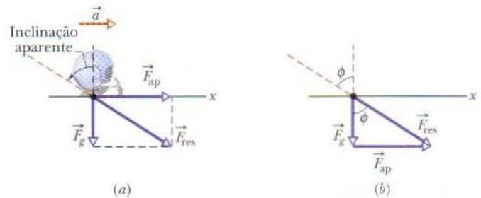
**FIG. 5-10** (a) A força  $\vec{F}_{ap}$ , dirigida para a direita, é aplicada ao piloto durante a decolagem. O piloto tem a impressão de que sua cabeça está inclinada para trás ao longo da linha vermelha tracejada. (b) O vetor resultante  $\vec{F}_{res} (= \vec{F}_g + \vec{F}_{ap})$  faz um ângulo  $\phi$  com a vertical.
