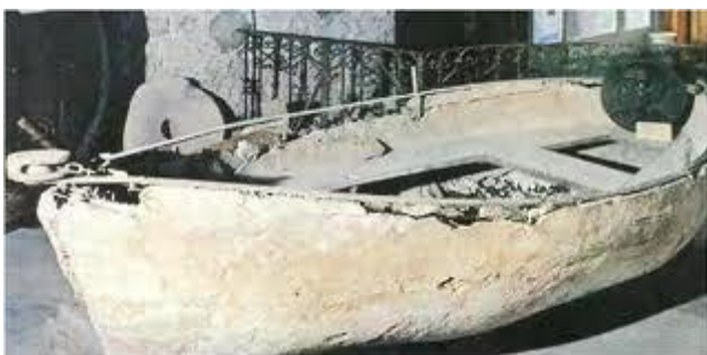
Figura 2 – O barco de Lambot media aproximadamente 4m de comprimento por 1,50m de largura com paredes de aproximadamente 4cm de espessura.
