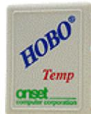
Figura 2 – Sensor HOBO de temperatura. Este tipo de sensor possui baixo custo e é bastante robusto.
