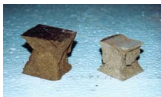
Figura 10: Rotura por compresión en probetas (5x5x14) cm.
