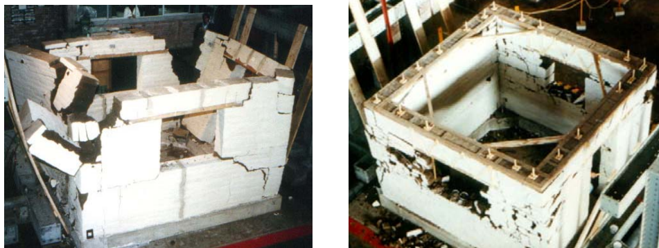
Fig. 16 – Ensayos de simulación sísmica de módulos de adobe sin y con refuerzo de caña.
