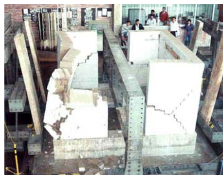
Fig. 17b – Ensayos de muros en U.
