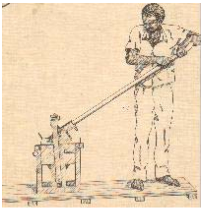
Figura 5 – Prensa manual CINVA-RAM.
