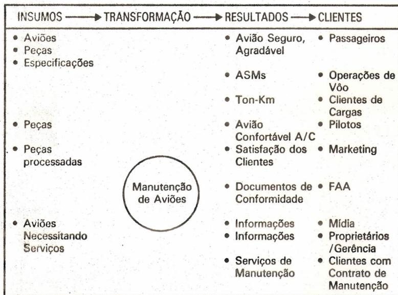
Quadro 4-4. Visão geral do processo de manutenção de aviões.
